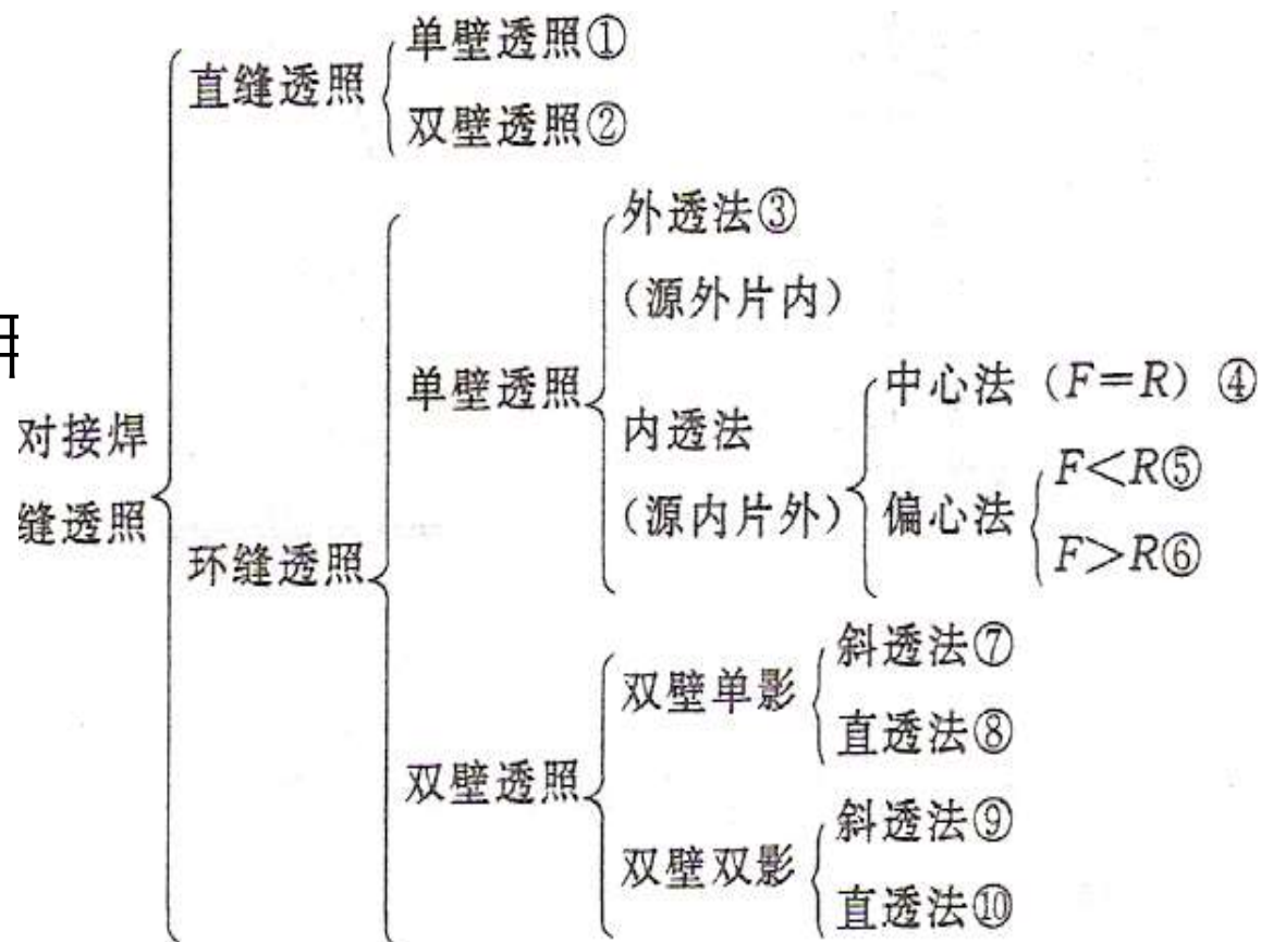
图 4—5 常用的对接焊缝透照的方式的分类
